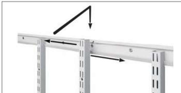
**2.** Зацепите вертикальные стойки через паз в рельсе и распределите их вдоль рельса так, чтобы расстояние между центрами стоек соответствовало ширине полок, корзин и других навесных элементов.
